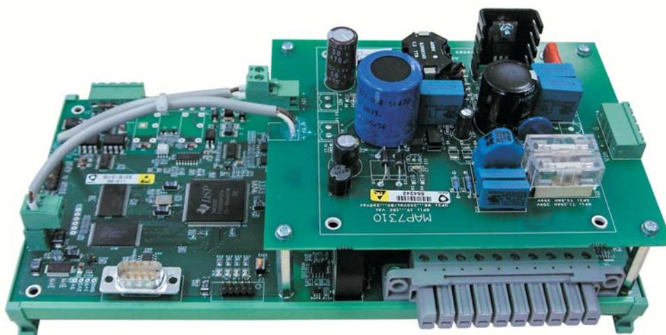
D 060 apresentado em suporte de plástico para fixação em calha DIN
